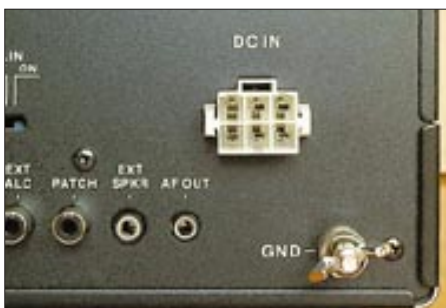
Bild 5: Einziger Rückfront-Unterschied zwischen Mark-V und nicht Mark-V: Netzbuchse sowie Sicherungselement fielen weg, und die 13,8-V-Standardbuchse wich einer ihr zwar sehr ähnlich aussehenden, ebenfalls sechspoligen, aber zu ihr doch verwechlungssicheren anderen Stromversorgungsbuchse.
