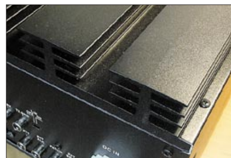
Bild 6: Markantester äußerer Unterschied zwischen Vorläufer und dem Mark-V sind vier dieser markigen Kühlkörper auf der linken hinteren oberen Gehäusefläche zur Abführung der in der 200-W-Endstufe anfallen Verlustwärme. Übriges tut ein in Richtung Front angeordneter breiter, aber leiser Querstromlüfter.
