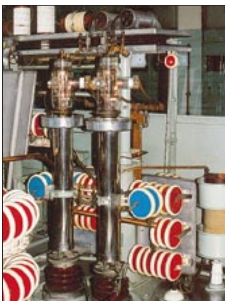
Ein Gegentaktzweig der 250-kW-Endstufe; das am linken Bildrand erkennbare Kuchenblech gehört zu einem Plattenkondensator.
