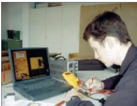
Silvan Polenz kontrolliert die Ruhestromaufnahme an dem Datenerfassungssystem AS53 des AATiS e.V., das hier als automatisch arbeitende Wetterstation eingesetzt werden soll.
