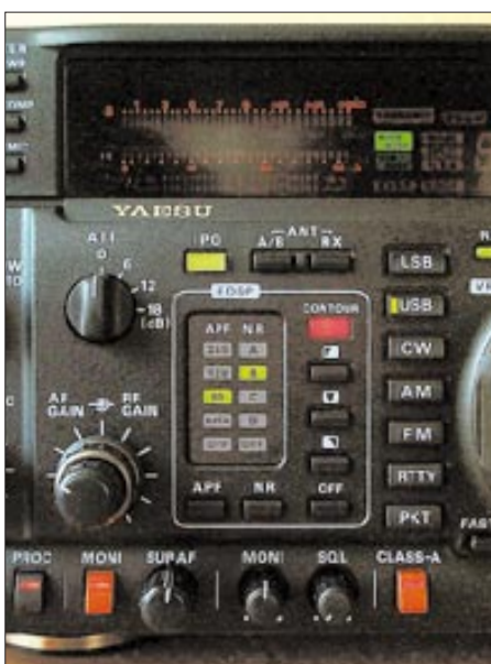
Bild 7: In dieser Frontplattenpartie dokumentiert sich zunächst die verbesserte Bedienung der DSP-Filter. Die vier DSP-Filterbandbreiten für Data sowie 60, 120 und 240 für CW sind nun bequem zugänglich, ebenso vier Grade der DSP-Rauschverminderung, die sich als durchaus genügend erwiesen. Daneben nun, bedientechnisch ja auch dazugehörig, die Tasten für die drei Kontur-Filter (früher ein Drehschalter auf der rechten Frontseite); eine Mehrfarb-Leuchtdiode zeigt dabei, welches eingeschaltet ist. Links unten ist zu erkennen, daß die Steller für die ZF-Verstärkung und die Lautstärke des Zweitempfängers vertauscht wurden. Die rechte orangefarbene Taste schaltet jetzt statt der User-Einstellung den A-Betrieb der Endstufe beim Senden ein.
