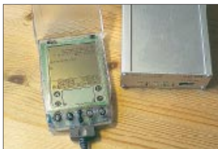
Bild 8: Verbindungsaufnahme zu einem TNC via Terminalemulation
